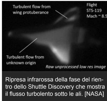
Ripresa infrarossa della fase del rientro dello Shuttle Discovery che mostra il flusso turbolento sotto le ali. [NASA]
