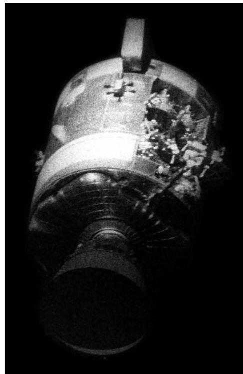
Il modulo di servizio dell'Apollo 13, con lo squarcio creato dall'esplosione di un serbatoio dell'ossigeno, fotografato dopo la separazione della capsula Apollo poco prima del rientro sulla Terra.
