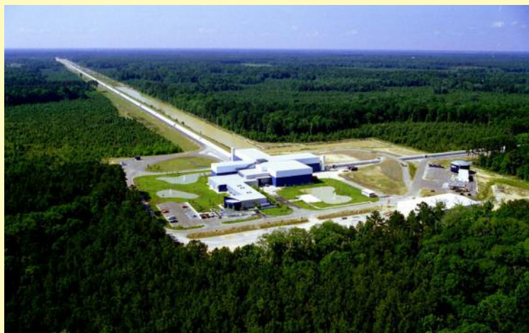
Veduta aerea del Laser Interferometer Gravitational-Wave Observatory, situato presso Livingston, in Louisiana. Sono riconoscibili i due bracci perpendicolari dell'interferometro laser. [Cortesia LIGO]
